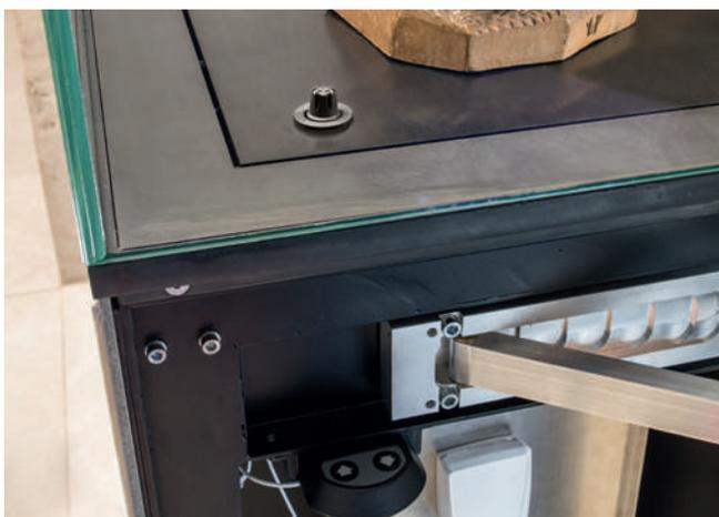
Fig. 2 – Soluzione pratica: sonda esterna che non dà nell'occhio integrata direttamente nella vetrina e data logger nascosto nello zoccolo
